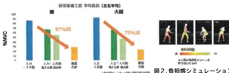
図1. 排泄介助の全行程における平均負荷の比較 (排泄準備工程 最大負荷シーン)
